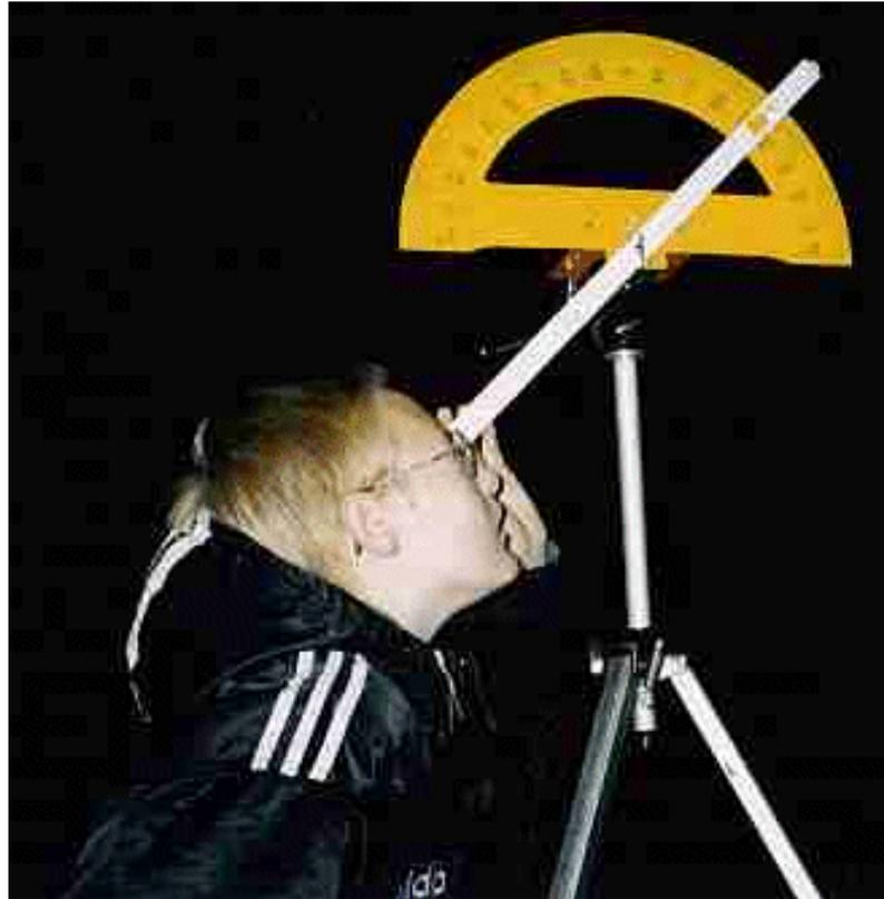
Mesure de la latitude en observant la hauteur de la polaire sur l'horizon.
